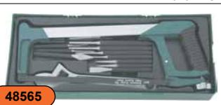
Содержание: ножовка, разводной ключ, зубила и выколотки
