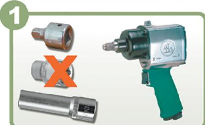
Не используйте торцевые головки, карданные шарниры, удлинители и другой ручной инструмент с пневматическим инструментом.
